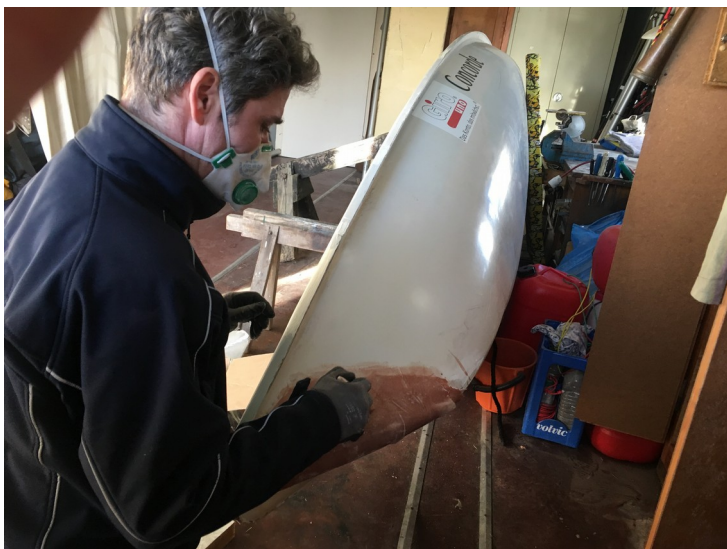
Trainer Marco Martens repariert einen Schaden an einer Laser-Jolle
